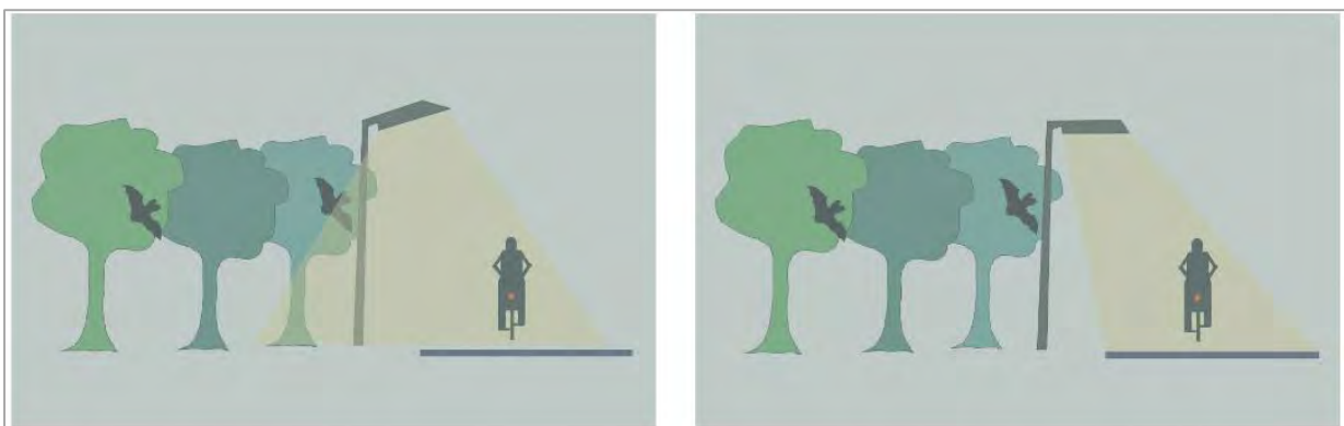
Abbildung 1: Verwendung abgeschirmter Leuchten zur Vermeidung unnötiger Lichtverschmutzung. Links: Konventionelle Beleuchtung mit Abstrahlung in den angrenzenden Waldlebensraum; rechts: Abgeschirmte Beleuchtung, die den Lichtkegel in die benötigten Verkehrsflächen fokussiert. Quelle: VOIGT et al. (2019).
