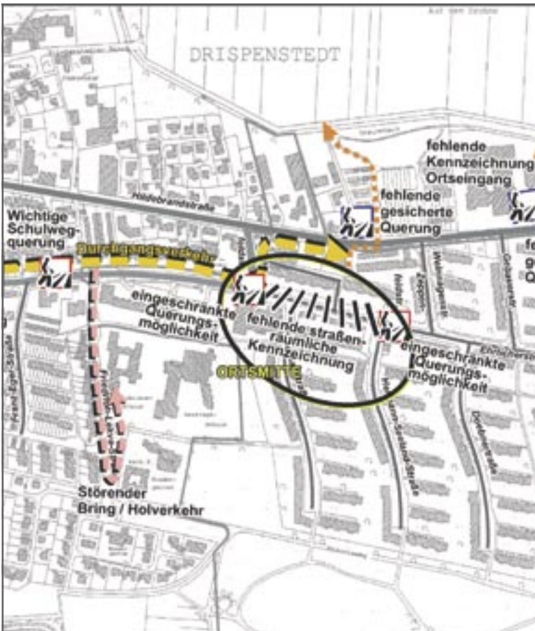
Mängelanalyse der Ehrlicherstraße vor dem Umbau (Ausschnitt)
