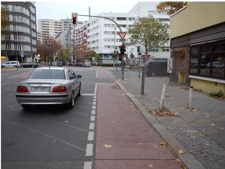
Abb. 13 Vorbeifahrstreifen in einer signalisierten Knotenpunktzufahrt mit zusätzlicher Rotmarkierung (Berlin)
