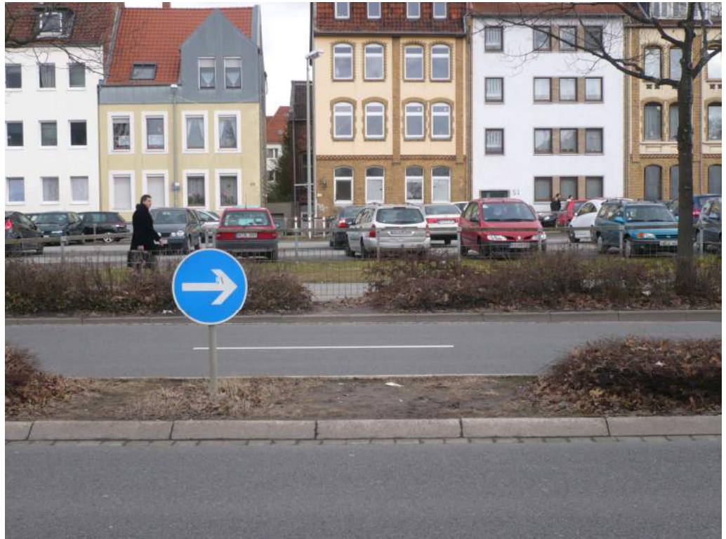
Abb. 65 Verhinderung des freien Überquerens durch einen Zaun an einer Hauptverkehrsstraße
