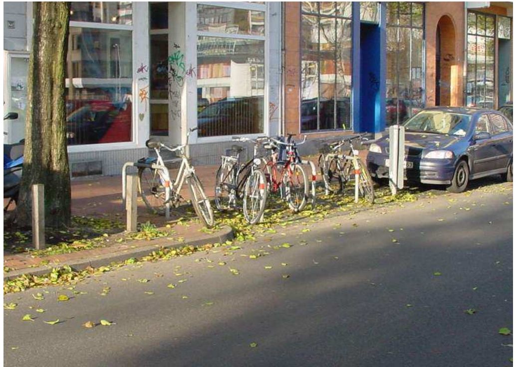
Abb. 59 Wohnungsnahe Radabstellanlage im Straßenraum durch Umnutzung eines Stellplatzes (Hannover)
